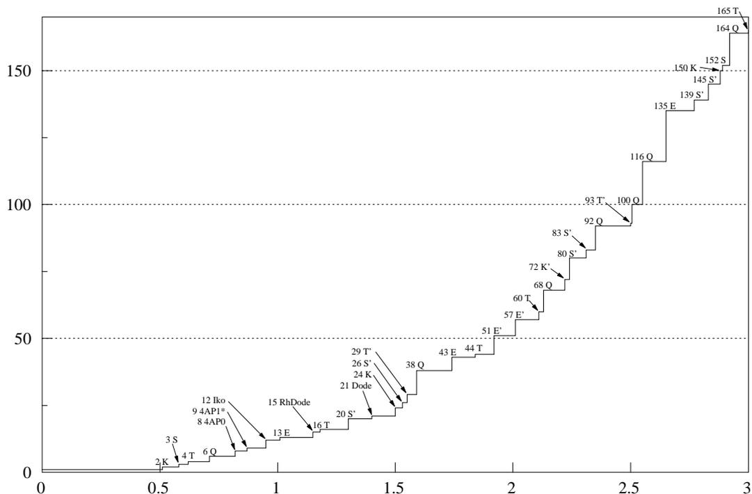
Man kann die verschiedenen Treppenfunktionen zu einer einzigen verschmelzen, wenn man bei gleichem Radius nur je die höchste Anzahl Kugeln in der Anordnung (die höchsten Stufen) zurückbehält. Im unteren Teil der Treppe sind auch die Anordnungen eingefügt, die nicht aus der dichtesten Kugelpackung stammen, wie das Ikoseder. Diese zusammenfassende Treppe kann dazu dienen bei einer neuen Kugelanordnung sofort entscheiden zu können, ob sie einen neuen Rekord darstellt. Sie muss dazu
